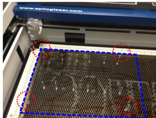
Mise en place des cales pour le support de la plaque
